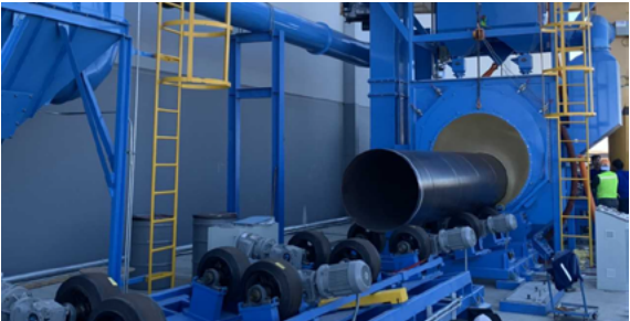
분진 집진 장비(State Pipe & Supply)
